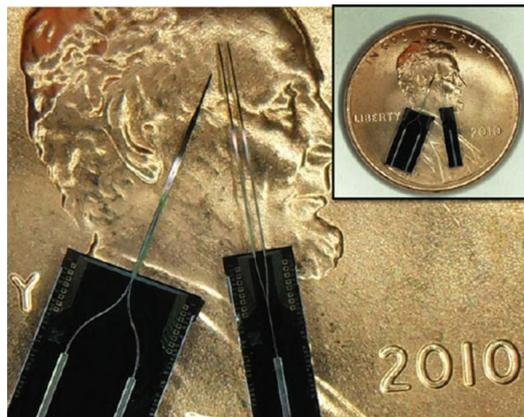
Figura 8. Sonda neural com aplicação em optogenética [adaptado de Im *et al.* (2011)].
