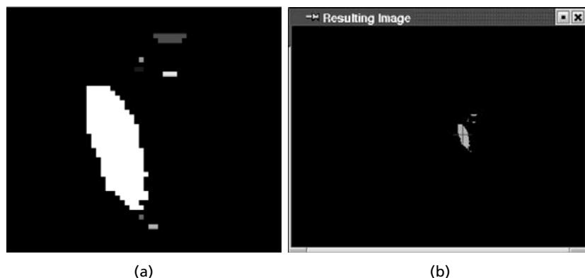
Figura 5. (a) Ilustração do processo de etiquetagem. (b) Indicação do centróide do maior objeto da imagem. Figure 5. (a) Illustration of the image labeling process. (b) Indication of the mass centre of the biggest object in the image.
