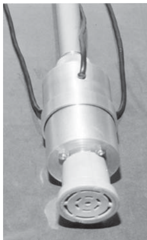
Figura 3. Transdutor já fixado em uma das muletas. Figure 3. Transducer implemented for the crutch
