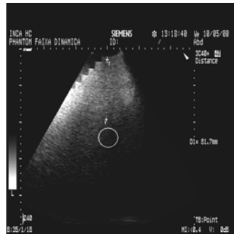
Figura 6b. O círculo indica a região onde os ecos estão no limiar da detecção para a Faixa Dinâmica nominal de 35 dB (degrau 0). Figure 6b. The circle indicates the region where the echoes are on the detection threshold to a nominal Dynamic Range of 35 dB (0 th step).
