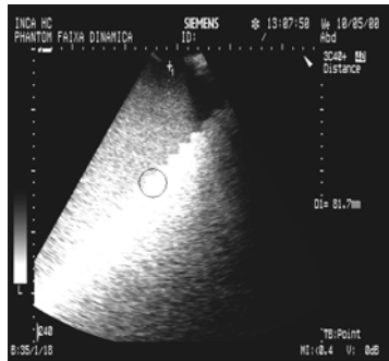
Figura 6a. O círculo indica a região onde os ecos estão no limiar da saturação para Faixa Dinâmica nominal de 35 dB (degrau 10). Figure 6a. The circle indicates the region where the echoes are on the saturation threshold to a nominal Dynamic Range of 35 dB (10 th step).
