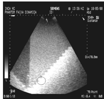
Figura 6e. O círculo indica a região onde os ecos estão no limiar da saturação para a Faixa Dinâmica nominal de 60 dB (degrau 19). Figure 6e. The circle indicates the region where the echoes are on the saturation threshold to a nominal Dynamic Range of 60 dB (19 th step).
