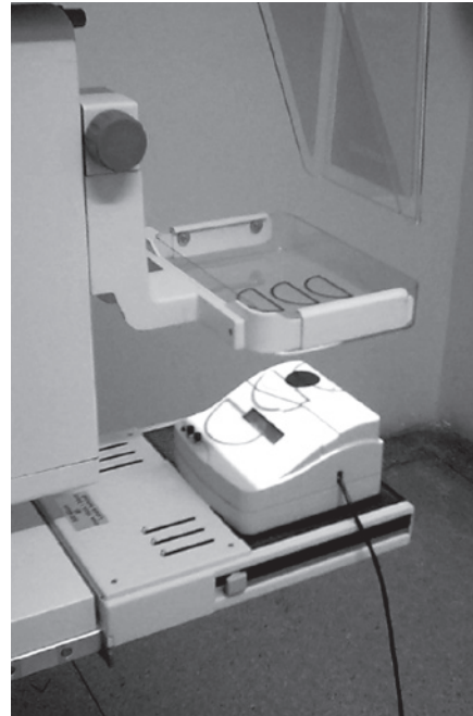
Figura 7. Posicionamento do MAMO-KVDT-01 no equipamento mamográfico. Figure 7. MAMO-KVDT-01 positioning in the mammographic equipment.
