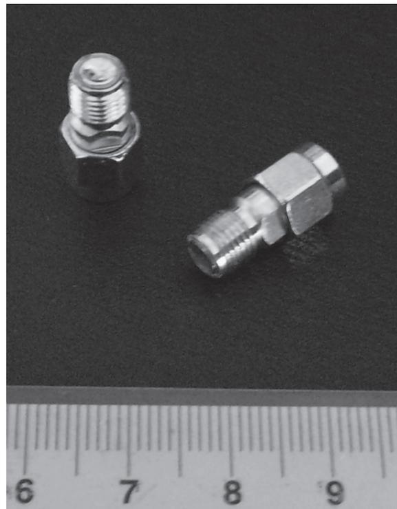
**Figura 2.** Transdutores monoelemento de PVDF, montados num conector tipo SMA. **Figure 2.** PVDF mono-element transducers, assembled in a SMA connector.
