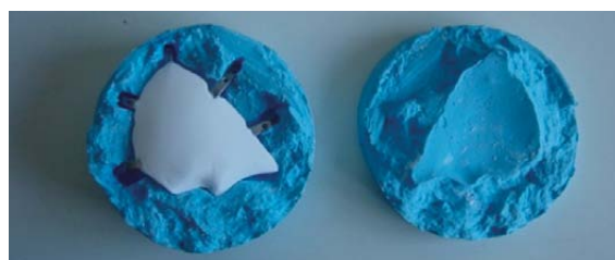
Figura 6. Molde para a fabricação do implante. A tela de titânio fica posicionada no interior e recoberta com cimento de fosfato de cálcio. Figure 6. Mold made to the production of the implant. The titanium mesh in positioned inside the mold and covered with calcium phosphate cement.
