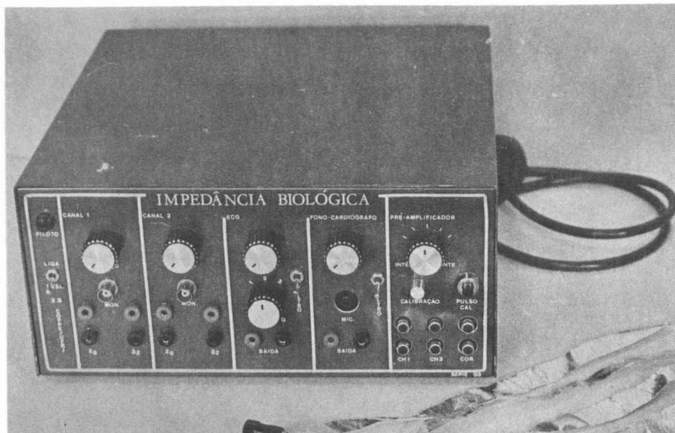
Figura 2. Equipamento desenvolvido para medição de impedâncias biológicas observando-se os controles de calibração não incluídos no diagrama da Figura 1.
