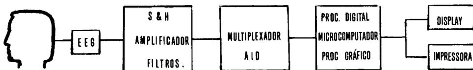
Fig. 1. Esquema geral do Sistema Experimental de Eletroencefalografia, mostrando as várias partes que integram o sistema.
