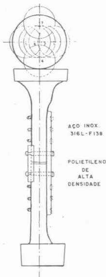
Figura 1 - Mostra a placa de aço inox 316-L, placa secundária de polietileno de alta densidade e os parafusos especiais com rebaiços. Mostra também a placa utilizada como controle, com o mesmo desenho e dimensões que a placa principal, somente com os dois furos centrais.
