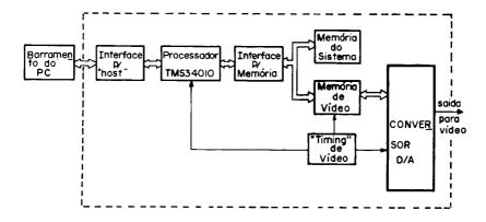
"Figura 1. Diagrama em Blocos do Sistema Mínimo."
