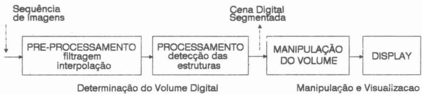
Figura 2: Do ponto de vista de desenvolvimento, um sistema para a manipulação e visualização de volumes médicos pode ser dividido em dois grandes blocos. O primeiro voltado para a identificação do volume digital e o segundo para a manipulação e visualização de volumes digitais de quaisquer natureza.
