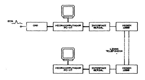
Figura 1 - Diagrama de blocos do sistema empregado.
